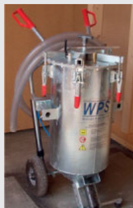
Pompe à mortier pour la création de l'appui au mortier de la lisse inférieure.
