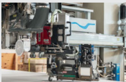
Figure 2 : Fixation mécanique par agrafeuse industrielle
