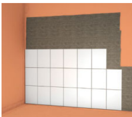
Illu. 7 : Les carrelages sont posés dans une mince couche de Mortier-colle flexible fermacell sur un film d'étanchéité en pleine surface (ce qui garantit l'étanchéité pour la classe de contrainte hydrique A).
